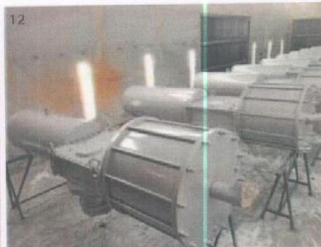
Fig. 11 - Piattaforma Offshore. Fig. 12 - Ciclo di verniciatura ecocompatibile qualificato C5M-H, C5I-H e NORSOK M-501 System 1, composto da 75 micron di HYDROGUARD® Zinc (primer zincante epossidico idrodiluibile a 3 componenti), da 175 micron di HYDROGUARD® HB (intermedio epossidico idrodiluibile ad alto residuo solido) e da 50 micron di HYDROTHANE® (finitura poliuretanica idrodiluibile)
