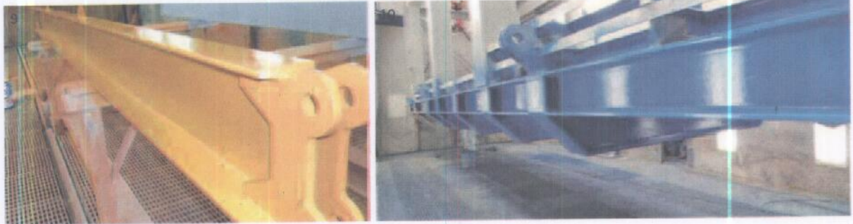
Fig. 9 – Ciclo di verniciatura ecocompatibile qualificato C3-H composto da 90 micron di HYDROGUARD® SZ (primer epossidico idrodilubile a rapida essiccazione) e da 50 micron di HYDROTHANE® (finitura poliuretanica idrodilubile). Fig. 10 – Ciclo di verniciatura ecocompatibile qualificato C5M-H, C5I-H e NORSOK M-501 System 7B, composto da 75 micron di HYDROGUARD® Zinc 78 (primer zincante epossidico idrodilubile a 2 componenti), da 175 micron di HYDROGUARD® HB (intermedio epossidico idrodilubile ad alto residuo solido) e da 50 micron di HYDROTHANE® (finitura poliuretanica idrodilubile)
