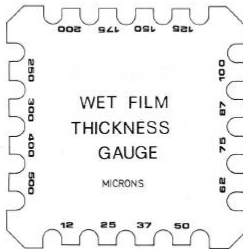
Rappresentazione grafica di un tipo di misuratore a umido detto "a pettine"
