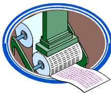
In questa macchina (Fig. 5) l'impasto arriva a un serbatoio (tina di macchina) e da questo passa a un dispositivo di alimentazione (cassa di afflusso) costruito in modo da garantire una distribuzione uniforme sulla tela della sospensione fibrosa sotto forma di un getto largo e sottile di
